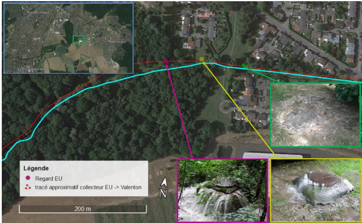
Extrait avis du SMAM : Débordement du collecteur intercommunal d'EU en aval de Roissy-en-Brie le 13 juin 2018
